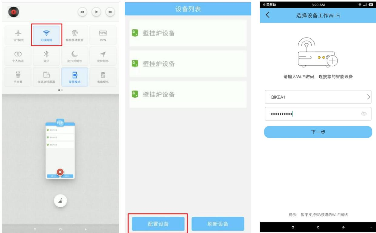
4. 根据提示，按下**壁挂炉设备的配网按键**(该按键由商家提供)，待壁挂炉设备的显示屏显示“A1”， 点击“我已完成上述操作”。
